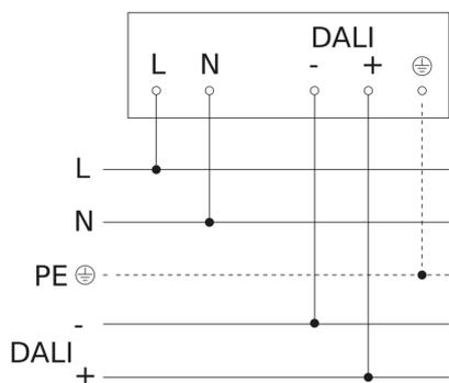
Schéma de câblage pour la mise en réseau DALI-2 APC & DALI-2 IPD
